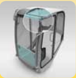
2 Der obere Scheibenteil wird einfach unter das Kabinendach geschoben. Dort ist er sicher verwahrt.
