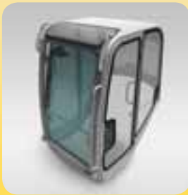
1 Voll verglaste Frontpartie: Hervorragende Sicht und perfekter Schutz vor Wind und Wetter. Ein tausendfach bewährtes Konzept. (Gekippte Stellung)
